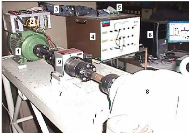
Figura 4.1 Sistema de pruebas integrado por: 1) Motor de 5 HP tipo jaula de ardilla. 2) Caja isotérmica donde se alojan las puntas de salida de los termopares. 3) Apantallamiento electrostático de las líneas de conexión. 4) Banco de resistencias. 5) Bus de conexiones a la tarjeta electrónica. 6) Computadora en cuyo interior se aloja la tarjeta PCI-6023E con conector de ranura tipo pci. 7) Banco de pruebas torquímetro. 8) Máquina de cd. 9) Bus de instrumentación para medición de torque y rpm.
